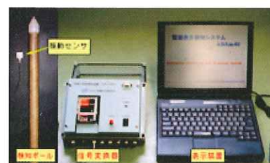
雪崩発生検知システム
