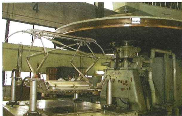
パンタグラフの集電性能試験
