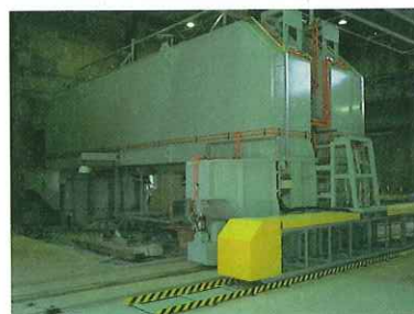
総合路盤試験装置
