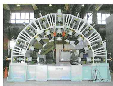
トンネル覆工模型実験装置
