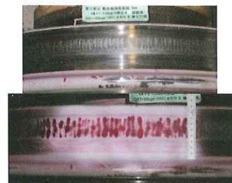
ブレーキ性能試験機で再現した 車輪踏面熱き裂
