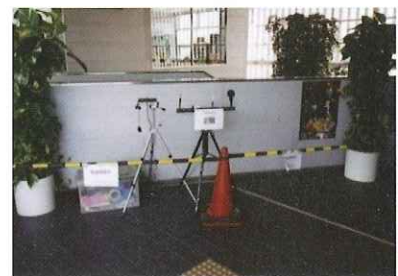
駅構内の環境(湿度・温度・照度)調査例
