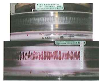
ブレーキ性能試験機で再現した 車輪踏面熱き裂
