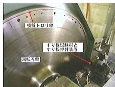
高速用集電材摩耗試験機
