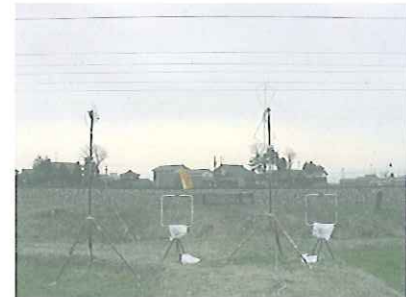
鉄道沿線における電波測定試験
