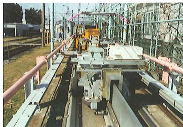
集電試験装置
