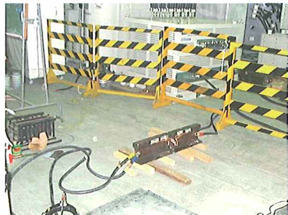
レールボンドの電流－温度特性試験
