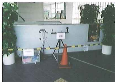
駅構内の環境(温度・湿度・照度)調査例
