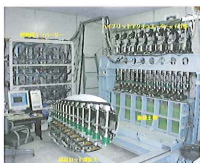
マルチアクチュエータ方式 小型移動載荷試験装置
