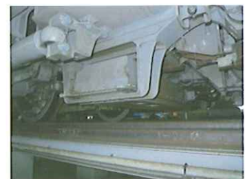
慣性正矢測定装置 (九州新幹線800系搭載)
