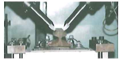
レール締結装置4軸疲労試験機
