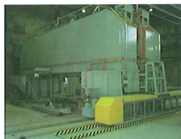
総合路盤試験装置
