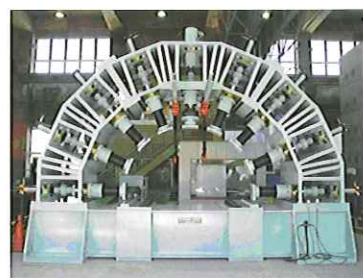
トンネル覆工模型実験装置
