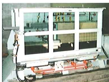
1次元中型振動台試験装置
