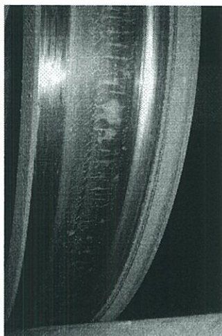
図5. 1 実車に発生した踏面熱亀裂
