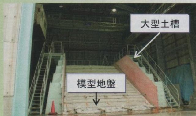
実物大盛土を用いた実験の様子
