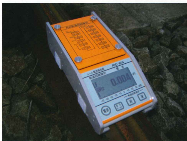
軌道回路レール電流検出器 RID-804
