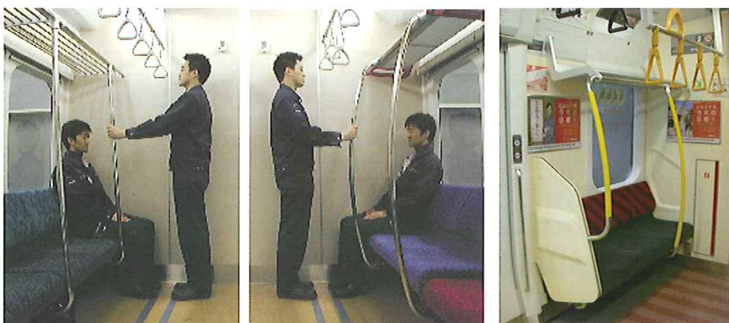
図1 従来の標準的な手すり(左)と円弧状縦手すり(中)とその実用化例(右)
