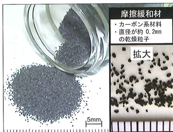
摩擦緩和材の外観写真
