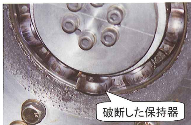
◆再現試験で破損した軸受
