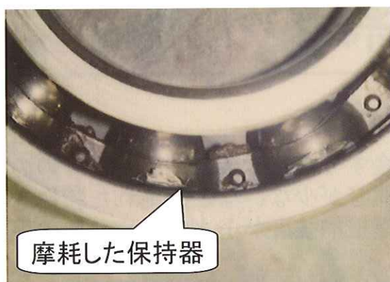
◆実際の車両で電食により 破損した軸受
