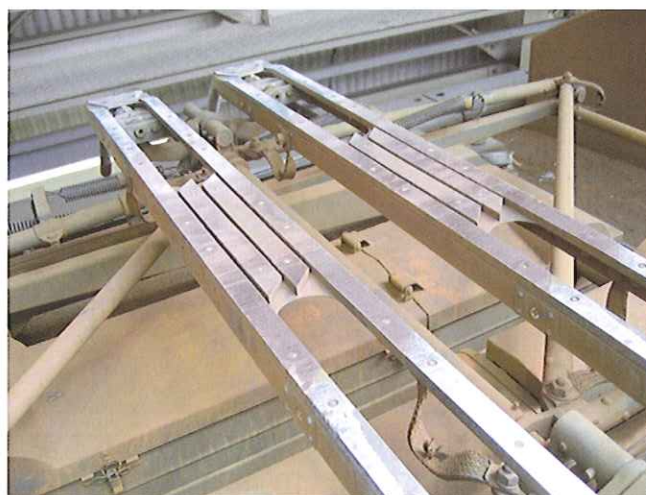
高潤滑性焼結合金すり板の取付け状態例
