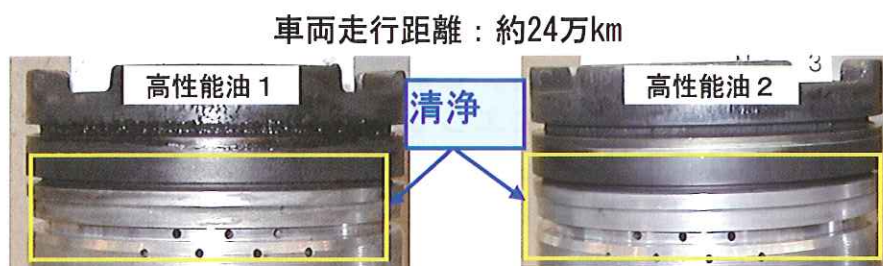
図2 現車試験後のピストン上部の状態
