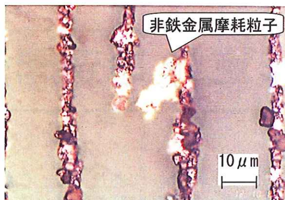
図1 潤滑油中の 10\mu\text{m} 以上の非鉄金属摩耗粒子
