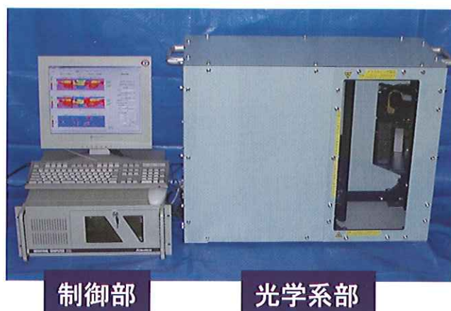
着氷雪量計測システム（左：制御部、右：光学系部）
