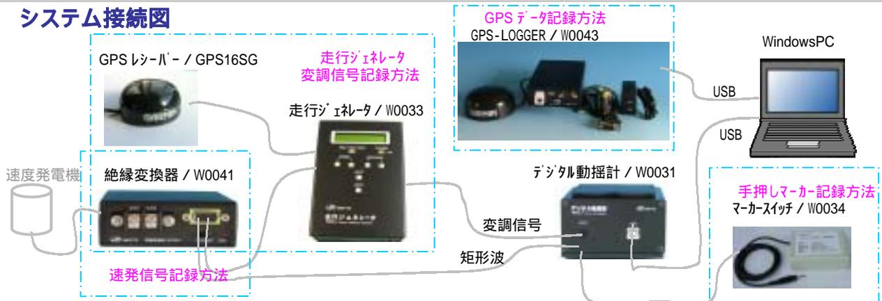
**手押しマーカー記録方法:** キロポスト、構造物等で目印にマーカーを入力します。
